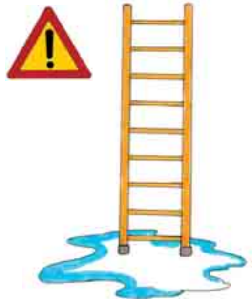
Fig. 24 - Appoggiare la scala su superfici non scivolose
