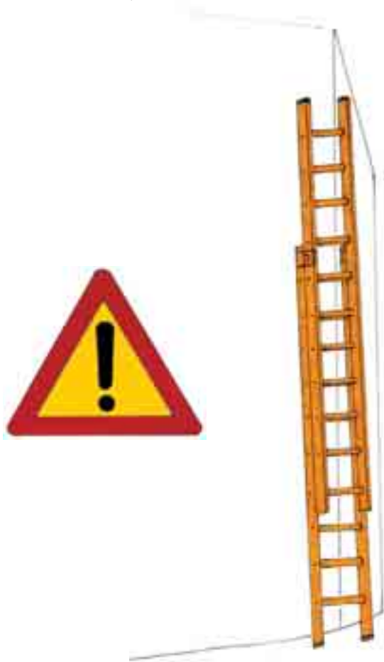
Fig. 18 - Errata posizione della scala su sostegno ad angolo
