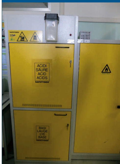
Figura 3 Armadio di sicurezza
